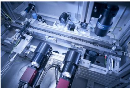
Die Stanzteilprüfzelle **KVC 621** vermisst und überprüft komplexe Geometrien und Konstruktionsgitter.
