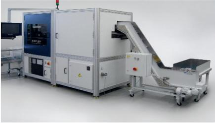
Die hocheffiziente Sortieranlage KVC 821 hat eine Sortierleistung von bis zu 500 Teilen pro Minute.
