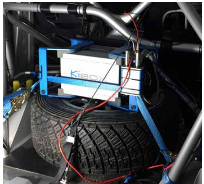
Das bewährte Indiziersystem von Kistler vereint die gesamte Hard- und Software zur Datenerfassung in einem kompakten und intuitiv bedienbaren Messgerät.
