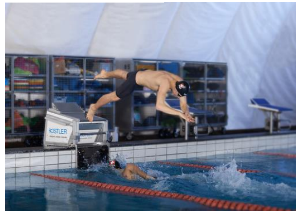
Mit dem Performance Analysis System for Swimming, Starts and Turns (PAS-S), kann unter anderem die Sprungkraft zur Optimierung des Starts gemessen werden.
