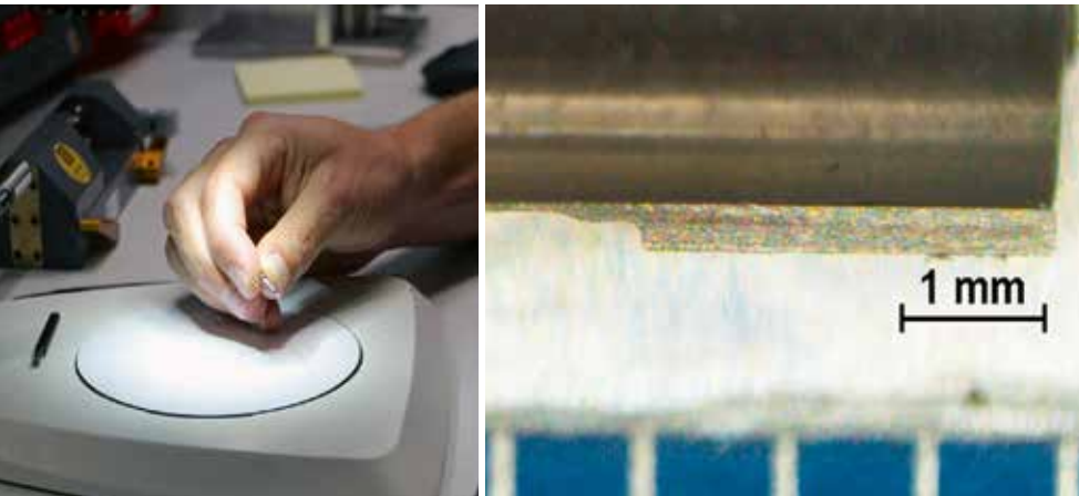
2 Weil die Drucksensoren von Kistler besonders empfindlich sind, müssen ihre Komponenten außergewöhnlich präzise hergestellt werden. Im linken Teil des Bildes ist zu sehen, wie eine der Hülse unter dem Mikroskop untersucht wird. Der rechte Teil zeigt den Längsschnitt durch eine Hülse. Ihre minimale Wandstärke von 0,06 mm verdeutlicht den Genauigkeitsgrad, unter dem die Zerspanung vonstatten geht (© Kistler)
