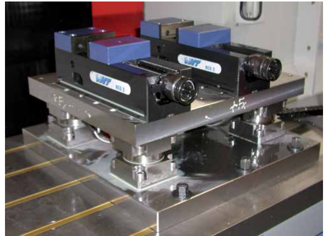
Abb. 1: Beispielhafter Anwendung eines 3-Komponenten Kraftaufnehmers, hier am Beispiel des Typens 9347C/9348C
