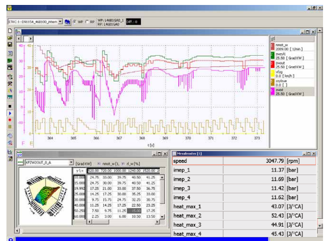
Bild 2: Indizierkennwerte am Bildschirm des Anwenders, integriert und synchronisiert in INCA
