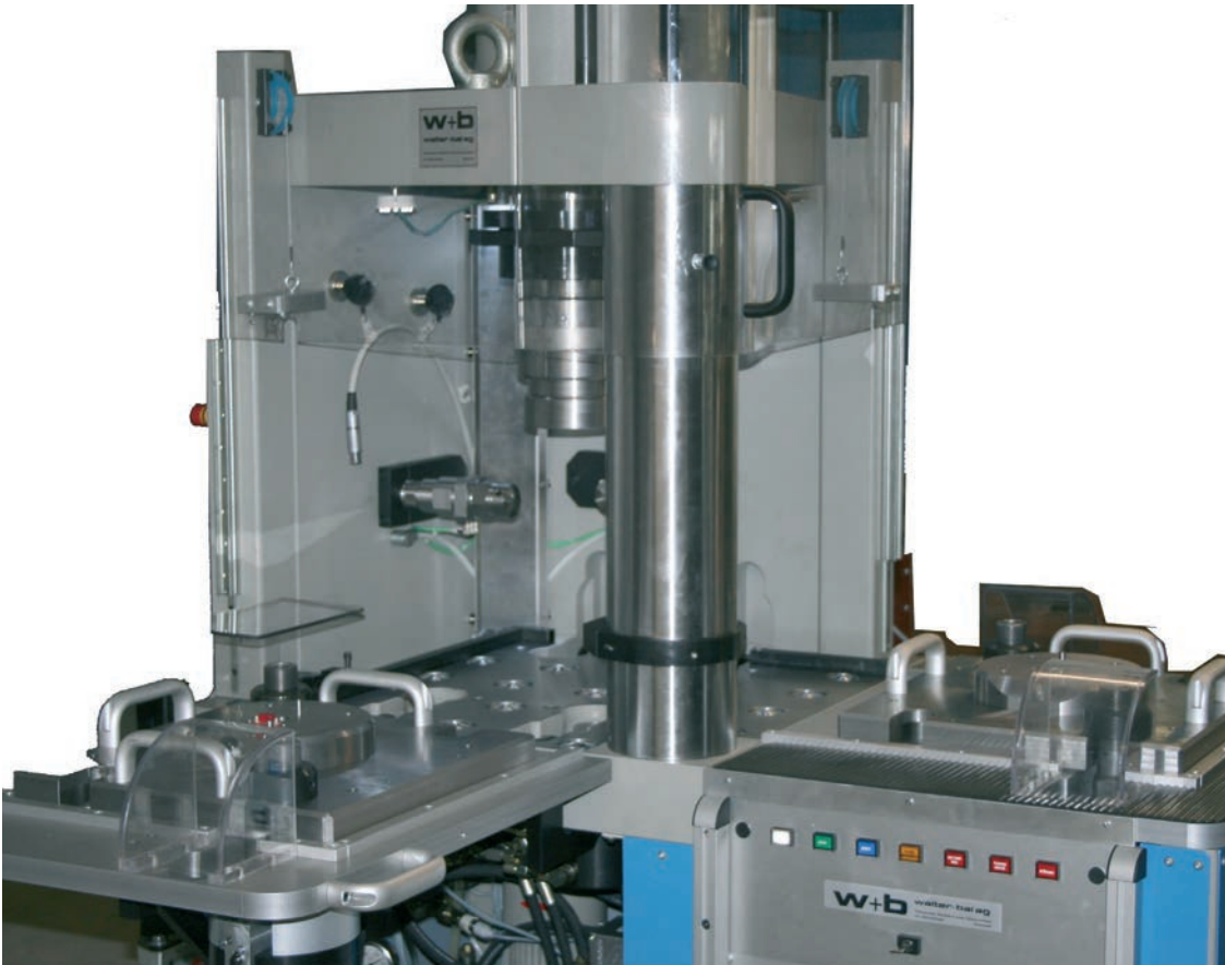
Bild 6: Mobile Kalibriereinheit für 3-Komponenten-Nachkalibrierung im Vollbereich (100 %FSO) der SmartCrash®-Kraftmesselemente beim Kunden vor Ort
