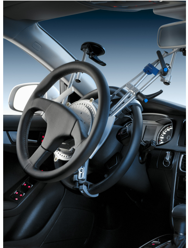
Bild 7: Montiertes Kistler Messlenkrad mit Lenkwinkelanschlag, Lenkradadapter und Statorbefestigung
