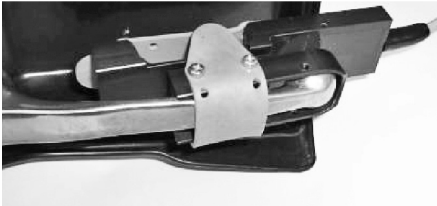
Bild 1: Am Motorrad-Handbremshebel montierter Sensor Typ CHFTA...
