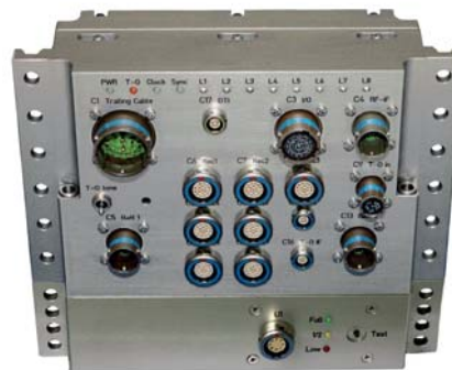
COMBox (oben) und USV-Stromversorgung (unten)
