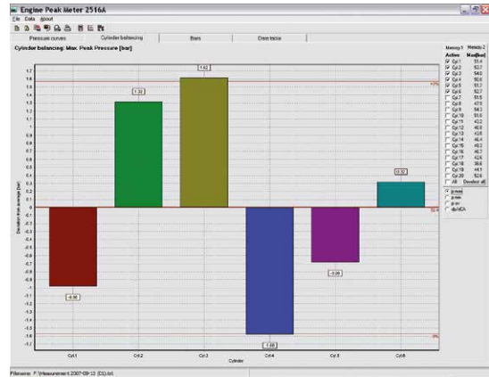
Bild 3: Streuung des Zylinderspitzendruckes p_{av} der einzelnen Zylindern eines 6-Zylinder Gasmotors, gegenüber dem rechnerisch ermittelten, durchschnittlichen p_{av} des Motors, vor und nach der Wartung ("as found" / "as left")
