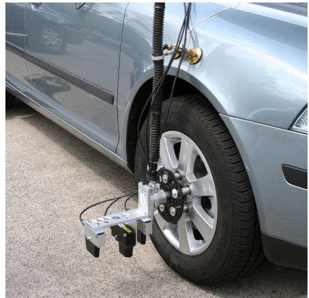
図2: DCAシステム取付け (オプションのタイヤスリップ角測定用のSFII-Pセンサ使用)
