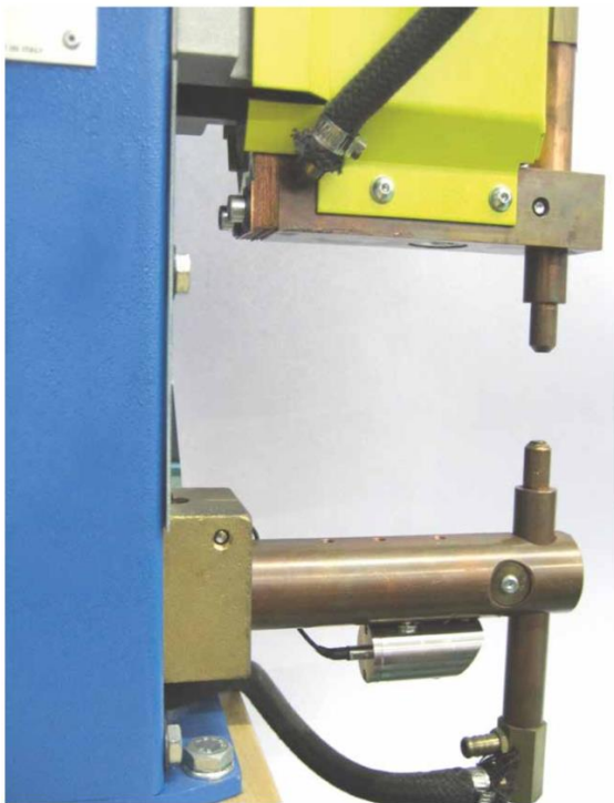
图 6: 在点焊机上利用 9237B10 型应变传感器, 对焊条夹紧力进行间接测量
