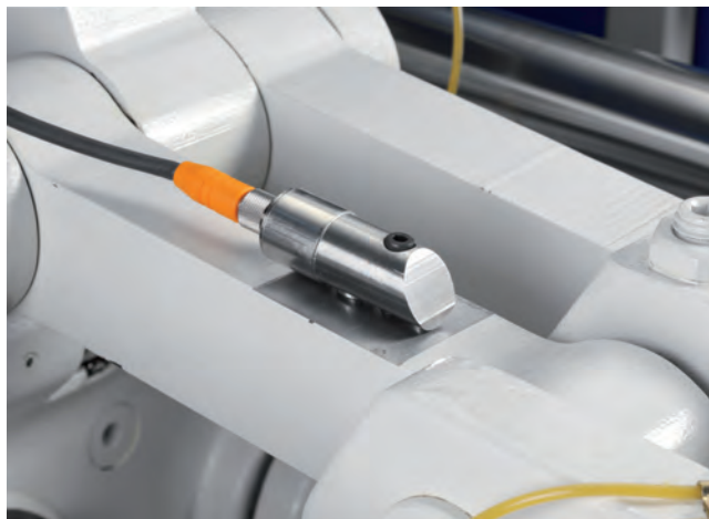
図8: ナックル継手にかかる力の間接測定
