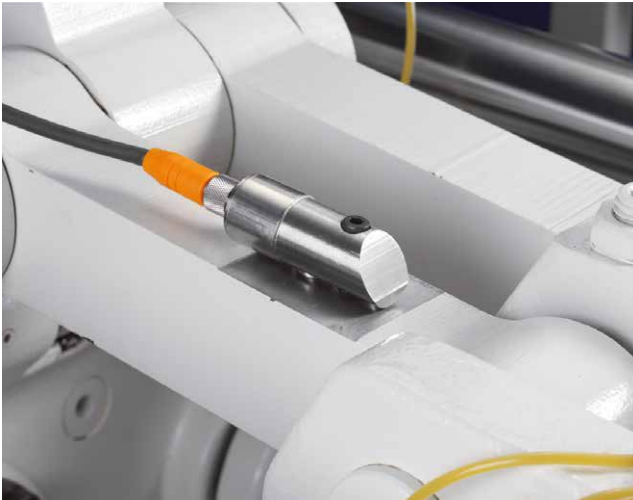
Bild 8: Indirekte Kraftmessung an einem Kniehebel
