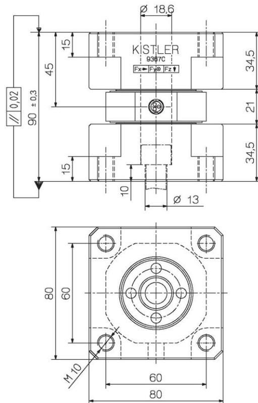
图 2: 9367C 型三分量测力链尺寸
