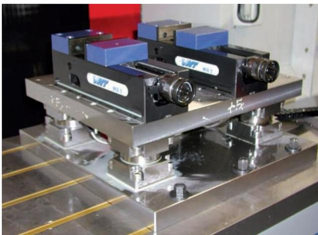
图 1: 由 4 个三分量测力链组成的切削力测力
