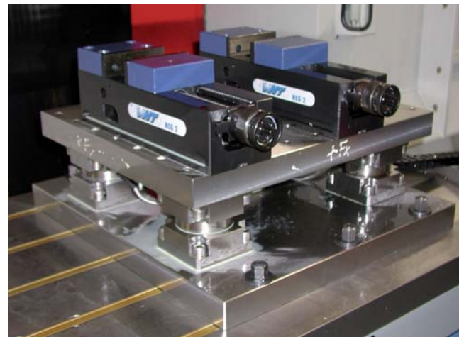
Bild 1: Schrittkraftdynamometer, gebaut mit vier 3-Komponenten-Kraftmesselementen
