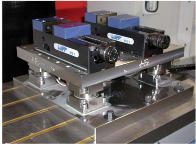
图 1: 由 4 个三分量测力链组成的切削力测力计
