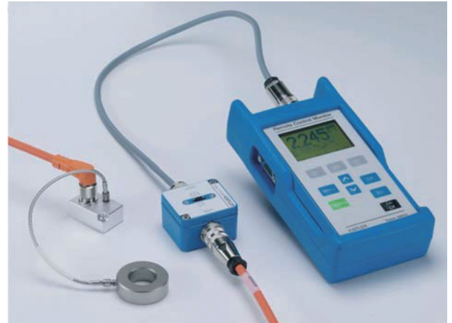
図 6: ミニアンプ 5030A、ロック解除インタフェース Z18796、との接続
