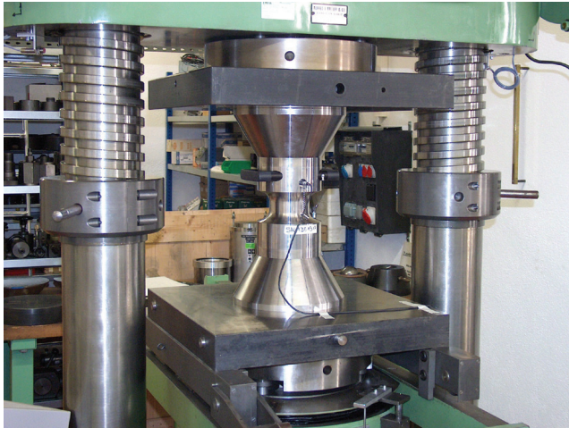
Bild 8: Meganewton Pressenkraft-Kalibriersensor Typ 9931A2 (5 000 kN)
