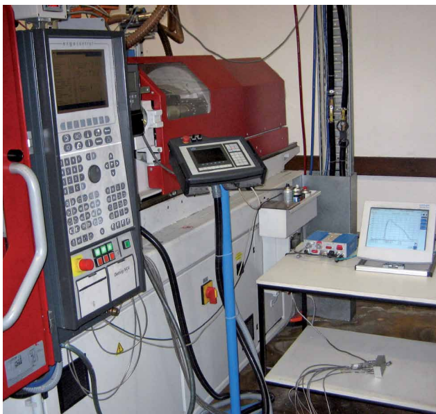
Ein Prozessüberwachungssystem CoMo Injection Typ 2869B2... von Kistler (rechts neben der Spritzgiessmaschine) überwacht die Fertigung von Steckverbindern
