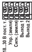
Рис. 3. Назначение контактов клемм с пружинным зажимом/кабельным вводом (для моделей с кабельным вводом)
