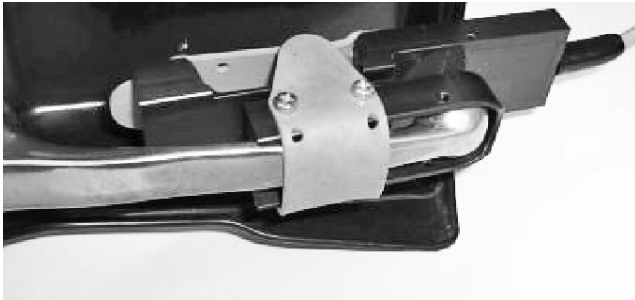
Bild 1: Am Motorrad-Handbremshebel montierter Sensor Typ CHFTA...
