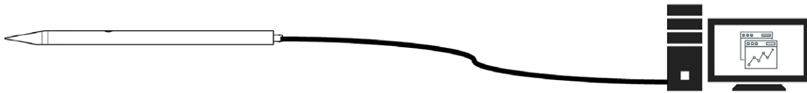
Bild 2: Typische Messkette für Taststift Typ 6233A...
