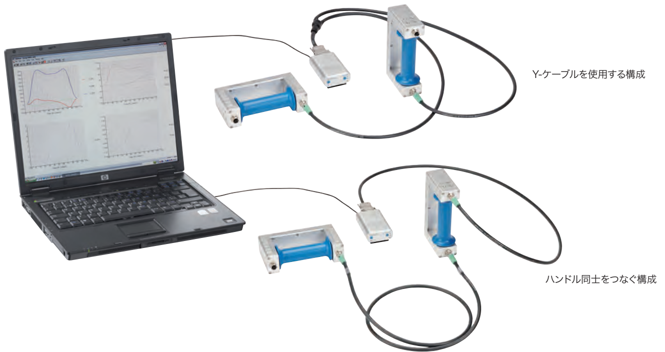
図 1: 測定システム例: USB インタフェースと2種類のケーブル構成
