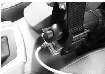
Bild 2: An der Handbremse montierter Sensor Typ CPFTB
