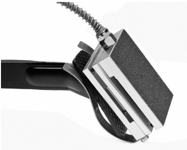
Bild 1: Am Bremspedal montierter Sensor Typ CPFTB
