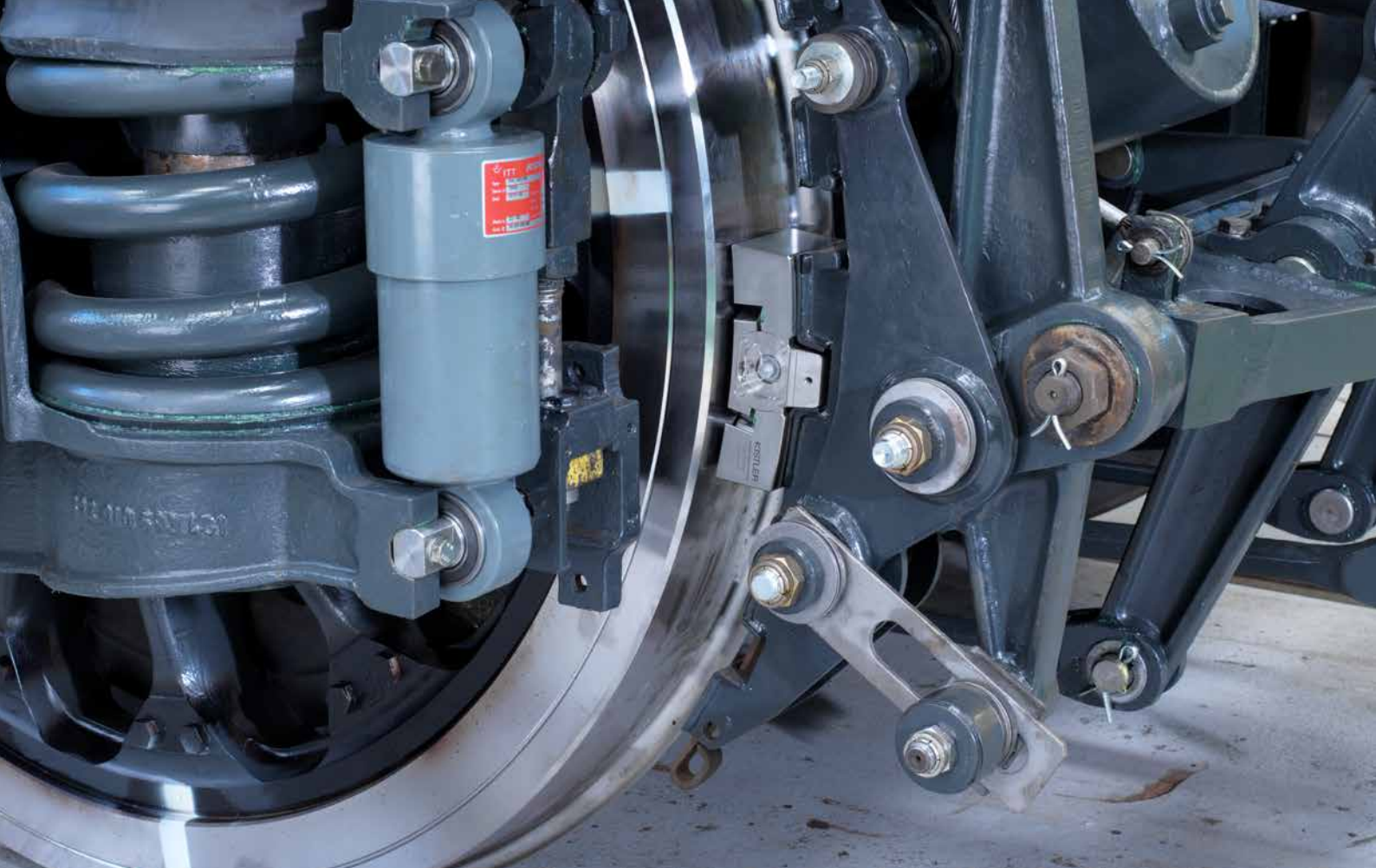
Bremskraft-Messelemente von Kistler anstelle des Bremsklotzes eingebaut: Bereit zum Testen der Bremskraft
