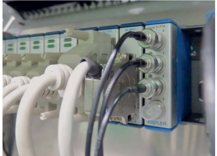
Das Ladungsverstärker-Modul Kistler Typ 5171A für CompactRIO™ im Einsatz
