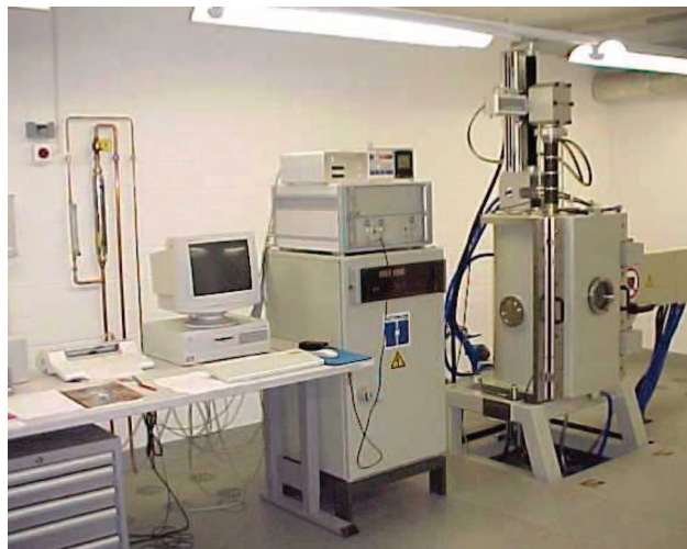
Kristallzüchtungsanlage nach Czochralski-Verfahren (Bild Kistler)
