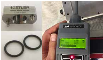
図1: シールリング、保護キャップ、漏れテスト装置
