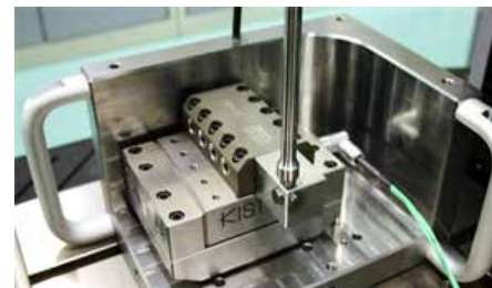
図2: 特別校正治具に取り付けた型式9129AAの旋盤加工用オプションでの加工点における校正
