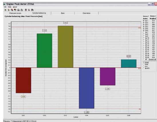
Fig. 3 : Variation de la pression cylindre de crête p_{av} de chacun des 6 cylindres d'un moteur à gaz par rapport à la p_{av} moyenne calculée du moteur, avant et après la maintenance. ("as found" / "as left")
