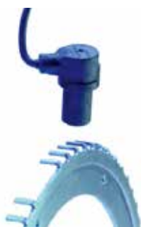
図10: エンジンの歯車付きクランクシャフト位置センサの処理
