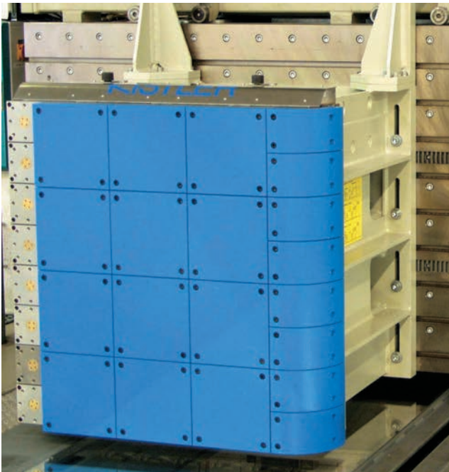
Bild 5: Standard SmartCrash®-Segment, vorbereitet für RCAR mit profilierten Aluminium-Eckelementen r=150 mm und Aluminium-Frontschutzplatten 250x250 mm
