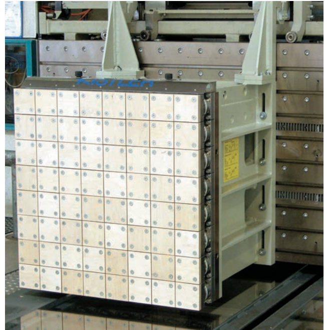
Bild 4: Standard SmartCrash®-Segment, vorbereitet für EuroNCAP mit Holzschutzplatten, ohne Deformationselement (Honeycomb)
