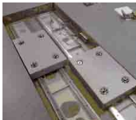
Einfache Installation und Vielseitigkeit: Zwei Messplattformen Typ 9281EA auf einem Rahmen mit variablen Einbaupositionen
