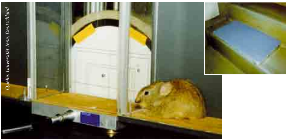
Messplattformen in Spezialgrößen, z.B. für Treppenstufen (270x500x35 mm, oben rechts) oder für Experimente mit Kleintieren (120x200x35 mm, unten) werden auf Kundenanforderung entwickelt
