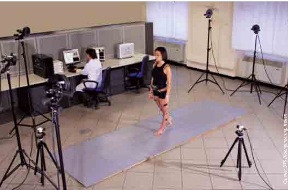
Ganganalyselabor mit Infrarotkameras und Messplattformen Typ 9286BA
