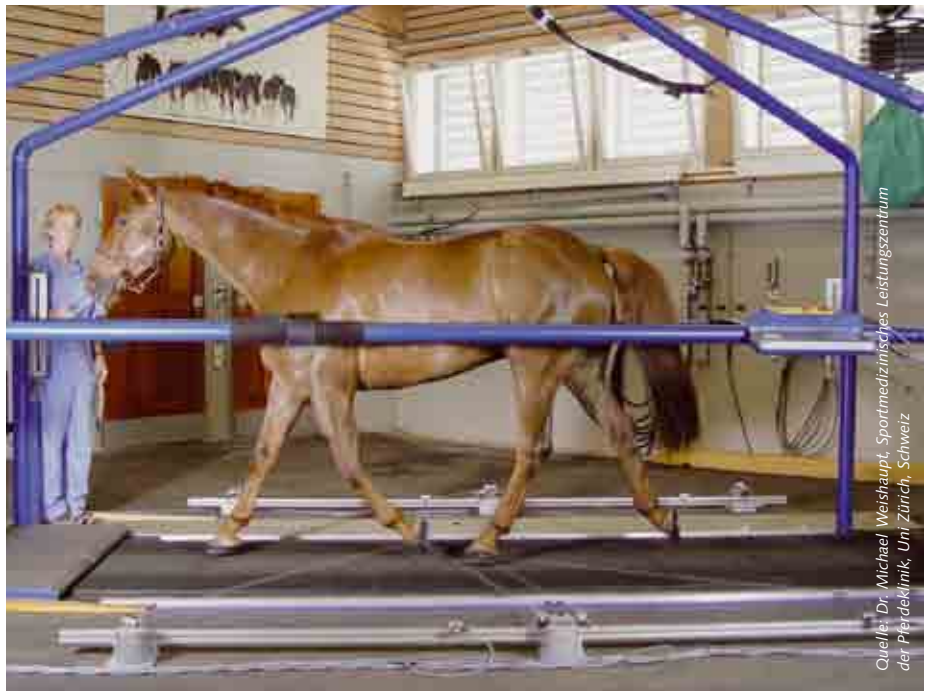
Instrumentiertes Pferdelaufband mit 18 Kraftsensoren von Kistler
