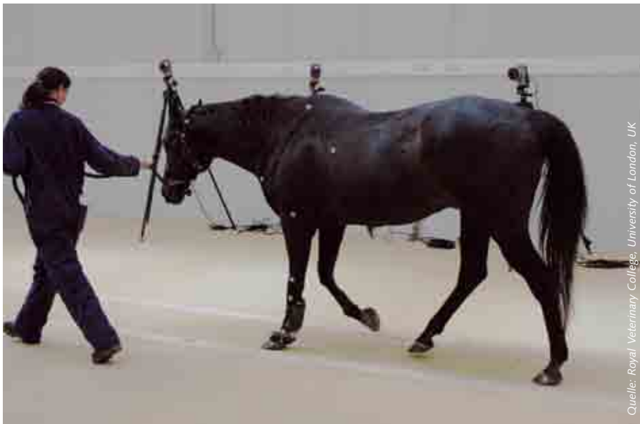
Ganganalyse an Pferden auf sechs im Boden installierten Messplattformen vom Typ 9287BA
