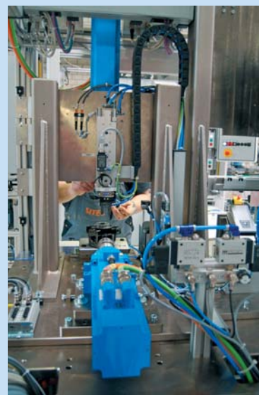
Montage avec modules d'assemblage NC chez le constructeur de machines SITEC
