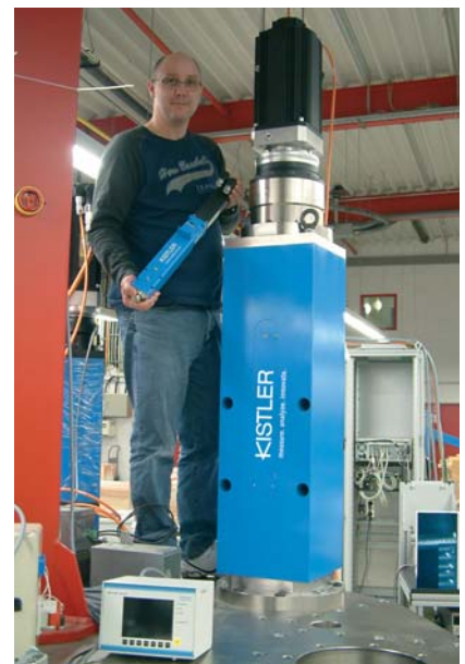
Martin Werner, directeur du service après-vente pour les systèmes d'assemblage NC, présente le plus grand et le plus petit des systèmes d'assemblage Kistler (NCFT : 0,5 kN/1 kN et NCFN : 300 kN)
